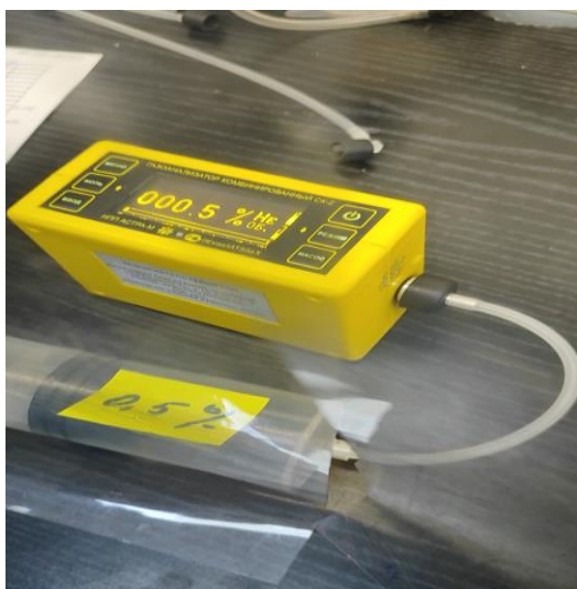
Испытания работы течеискателя на эталонной смеси 0,5% гелия
