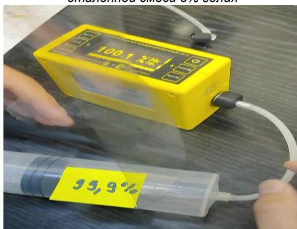
Испытания работы течеискателя на эталонной смеси 99,9% гелия
