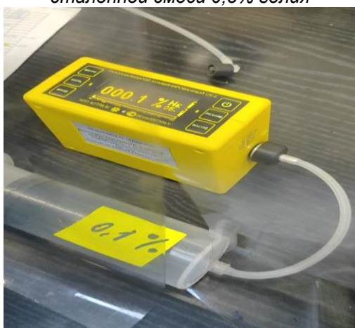
Испытания работы течеискателя на эталонной смеси 0,1% гелия
