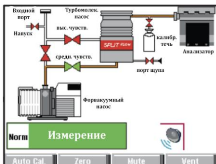
Вакуумная схема и меню течеискателя ZQJ-3200
