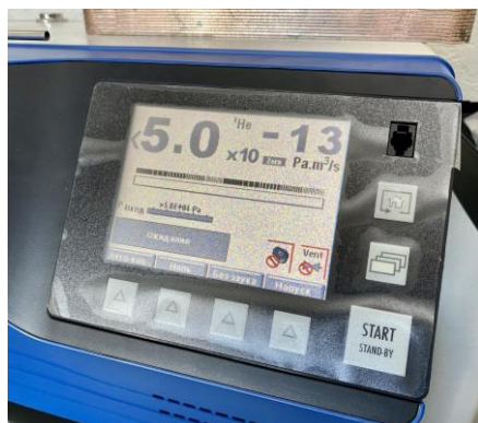
Отображение потока на течеискателе (установлена защитная пленка)
